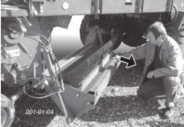
Ausschwenken des Messerbalkens auf die linke Wagenseite
