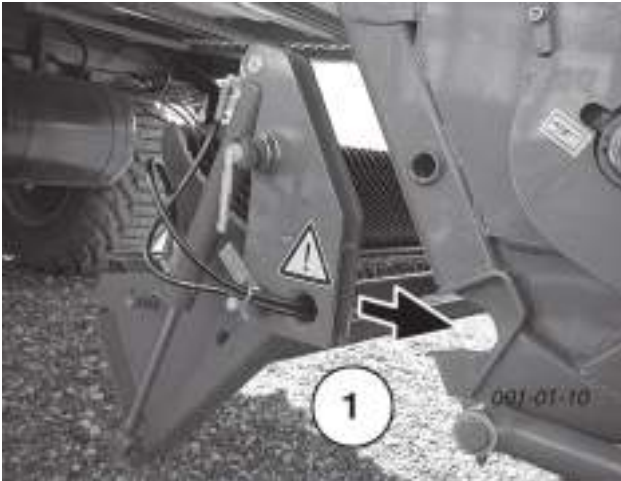
Einstellung mittels Schraube (SK-4) an der Schwenkachse des Messerbalkens.
